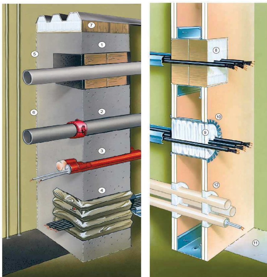
Rys. 2. Zabezpieczone przepusty instalacyjne
